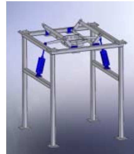
Estructura inferior con apoyo abatible como dispositivo de descarga
