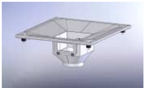
Apoyo para Big-Bag con puerta para desatar
